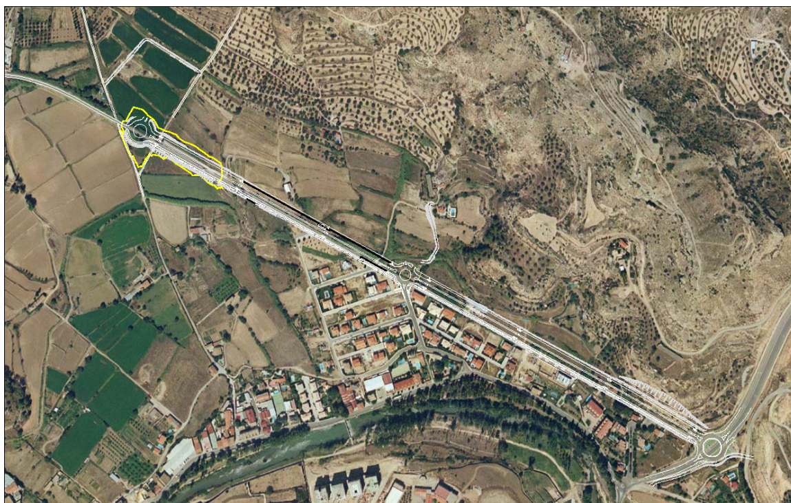
Zona de suelos de cimiento del terraplén con potenciales problemas de asiento diferidos de consolidación.
